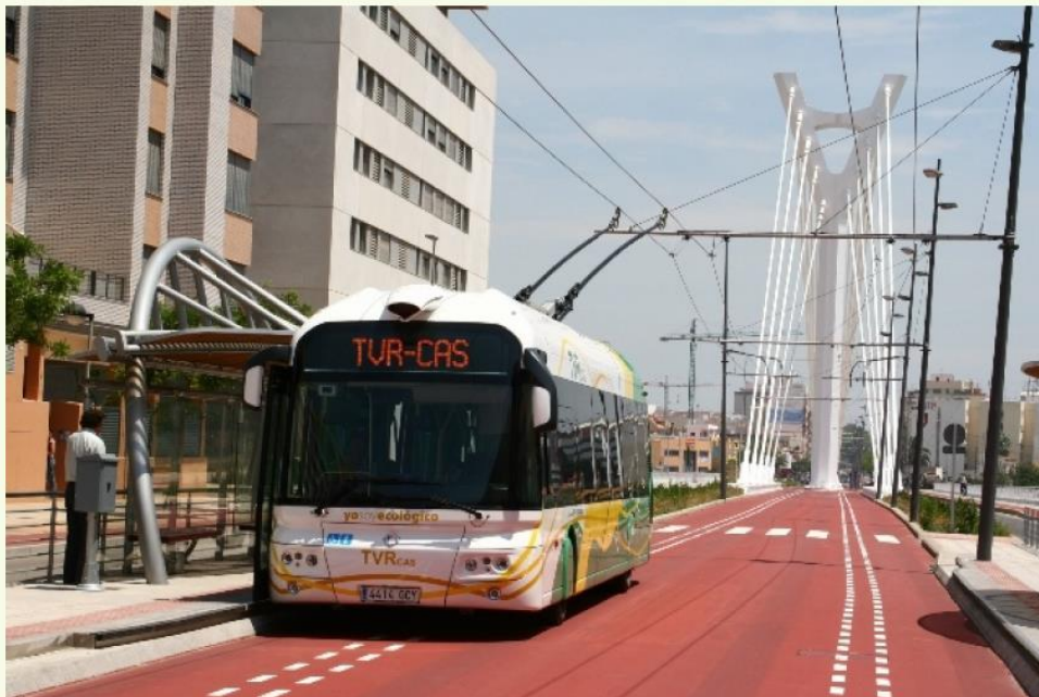
Trólebus dotado de guiagem ótica - Castelon - Espanha
