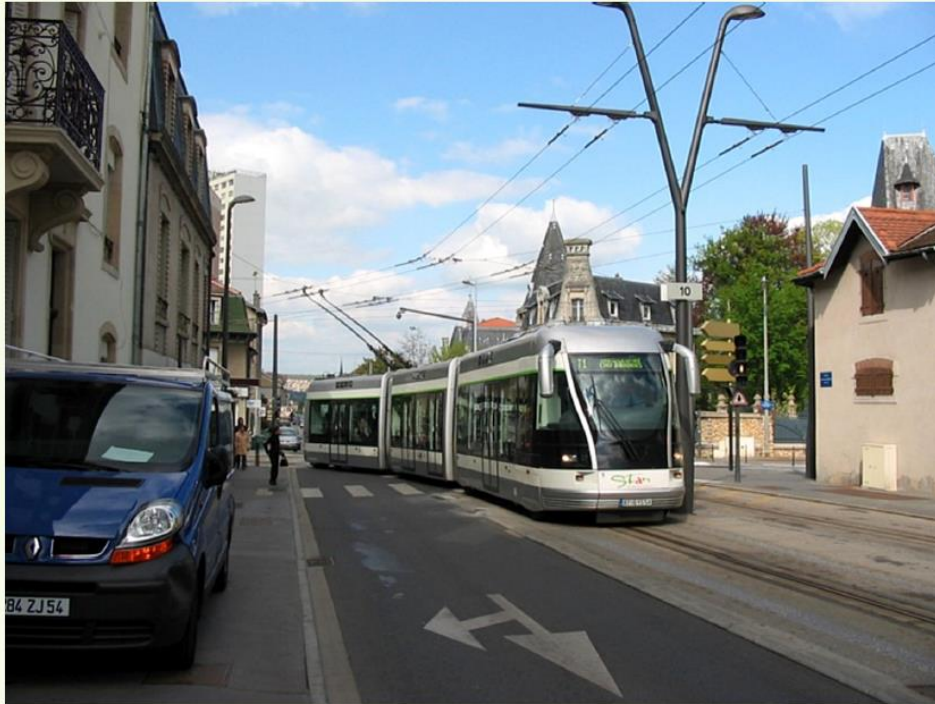
Trólebus dotado de guiagem mecânica (trilho) - Nancy - França
